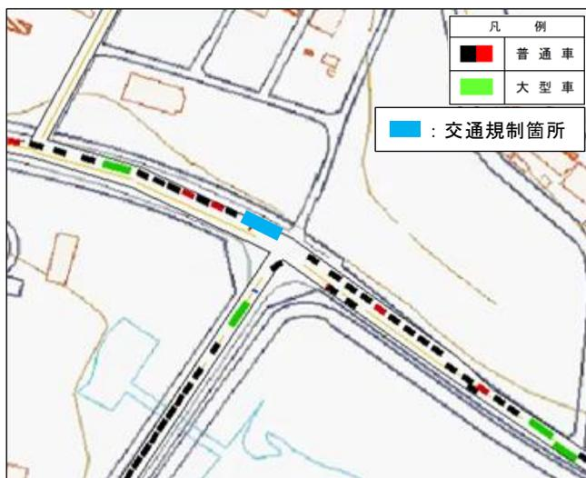
図-7 施工時シミュレーション結果
