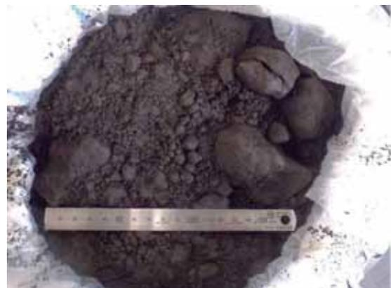
図-2 採取試料「脱水処理土（沼川）」
