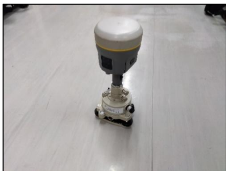
図-4 TrimbleR12 (VRS 方式)
