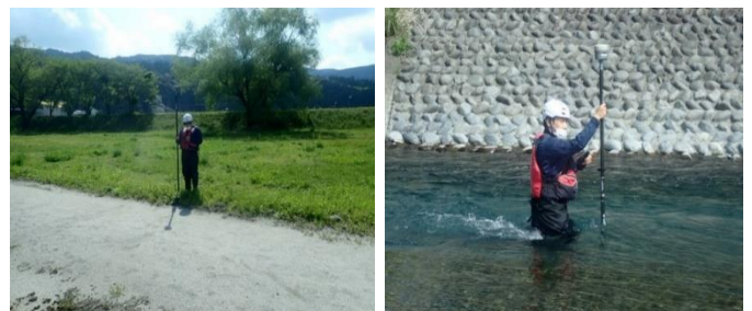
図-5 GNSS 測量機を用いた補備測量状況
