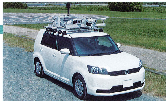
MMS全景写真(車上部にカメラやレーザスキャナ、GNSS/IMUを搭載)
