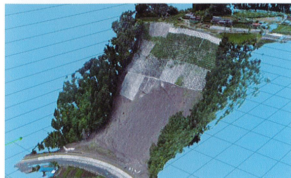
ドローンによる撮影写真から作成された3次元データ
