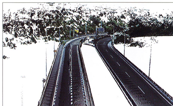
MMSにより取得された3次元データ
