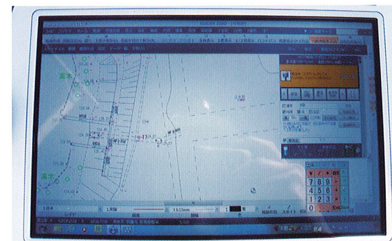
GNSS測量による電子平板
